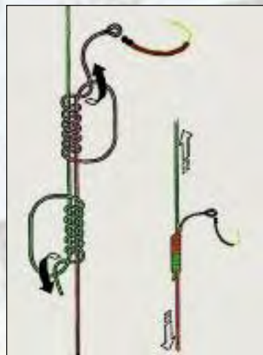
Esecuzione del nodo per realizzare le amettiere.
