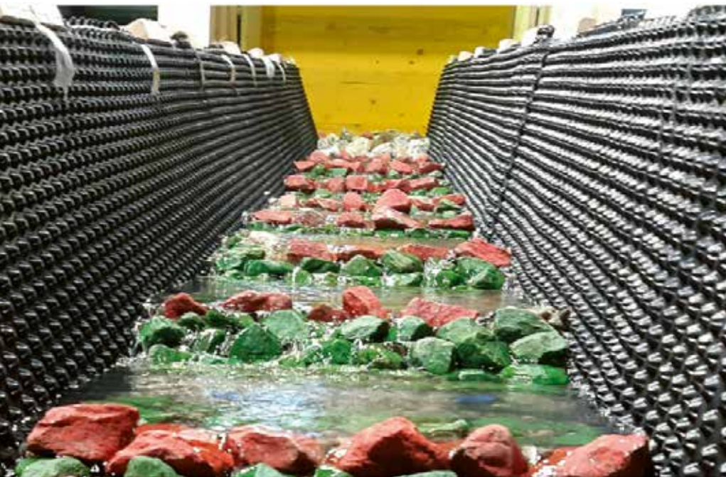
La Maira ricostruita in laboratorio; nella foto è rappresentato un deflusso di magra successivo a un carico della struttura equivalente a un deflusso centenario. L'eterogeneità di ogni traversa in blocchi offre, a dipendenza delle condizioni di deflusso, diversi corridoi di risalita per i pesci.
