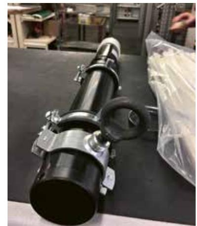
Idrofono, strumento in grado di rilevare i trasmettitori acustici nel raggio di circa 500 metri.
