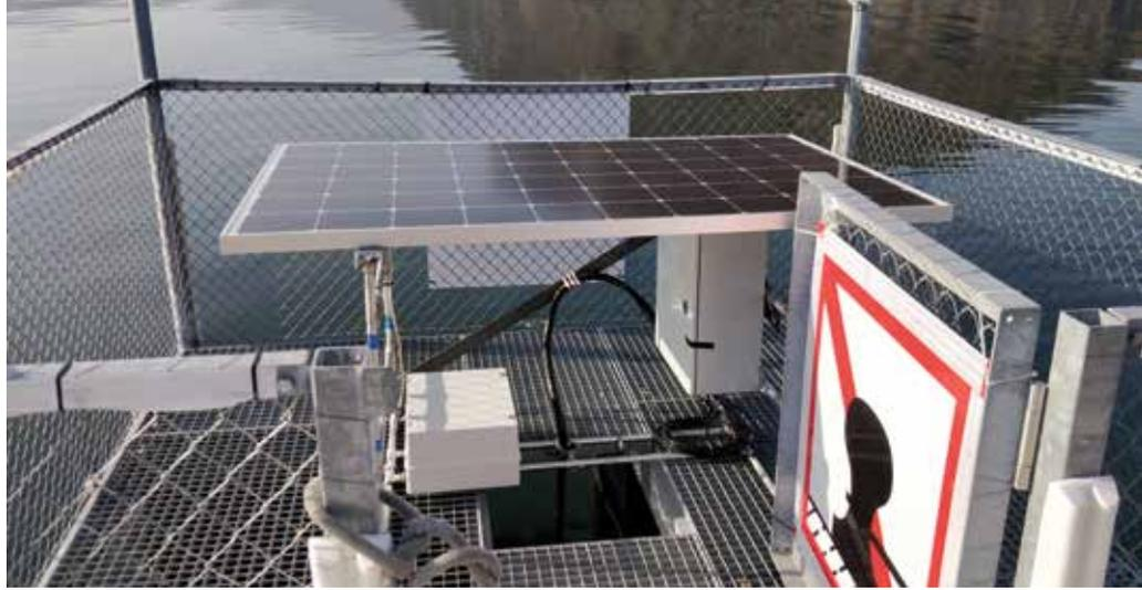
Figura 3 – Dettaglio del sistema installato alimentato ad energia solare per la misurazione dei parametri chimici e fisici del lago.
